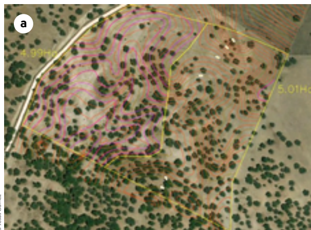
Figura 11 Desenho de Keyline, recorrendo ao programa Autocad, a aplicar às parcelas 3 a) e 5 b) das explorações A e B, respetivamente.
